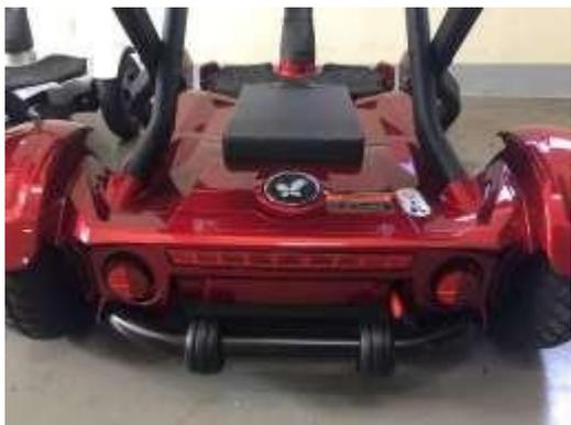
Accionamiento de la palanca de rodada libre - La fuerza máxima requerida del pie en la palanca es 19N para accionar y 35 N para desconectar
