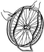
Colocar la guía de la llanta en posición por encima de la válvula de aire antes de insertarlo en la llanta. A continuación, la guía de la llanta se puede colocar por encima fácilmente. Comprobar que todos los extremos de los radios están cubiertos (la guía de la llanta no es necesaria en el caso que la llanta sea de plástico).
