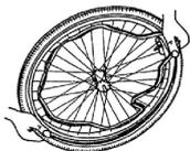
Presionar el neumático sobre la llanta, empezando por detrás de la válvula. Hinchar la cámara ligeramente hasta que empiece a redondearse y colóquela dentro del neumático.
