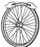
Cuando la cámara se encuentre dentro de la rueda sin arrugarse (si presenta arrugas, deje salir un poco de aire), se puede montar la parte superior de la rueda con facilidad presionando con ambas manos empezando de nuevo por la válvula. Empujar ligeramente la válvula hacia adentro y tire de ella hacia fuera de nuevo para garantizar que el neumático quede bien colocado alrededor de la válvula.
