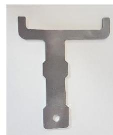
Figura 3 *Abridor de la caja de control*
