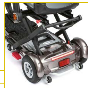
Palanca de desembrague y ruedas antivuelco. Luz trasera
